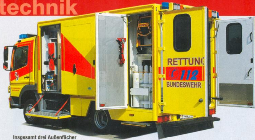
Insgesamt drei Außenfächer sind im Kofferaufbau untergebracht. Das Fach vorne links ist mit einer Schiebetür ausgestattet.
