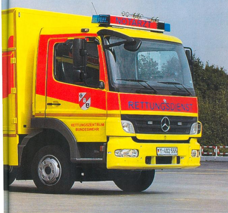
Zur einfachen Trageentnahme lässt sich die luftgefederte Hinterachse des Fahrzeugs absenken. Im Patientenraum befinden sich vier Sitzplätze für medizinisches Personal.
