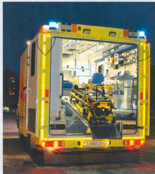
Zur einfachen Trageentnahme lässt sich die luftgefederte Hinterachse des Fahrzeugs absenken. Im Patientenraum befinden sich vier Sitzplätze für medizinisches Personal.
