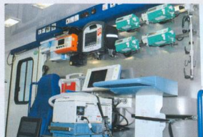
Die medizinische Ausstattung der beiden NAW/ITW entspricht dem Equipment der MedEvac-Flugzeuge der Bundeswehr. Dazu zählen ein intensivmedizinisches Beatmungsgerät (Bildmitte) sowie ein Blutanalyse- und ein Ultraschallgerät.
