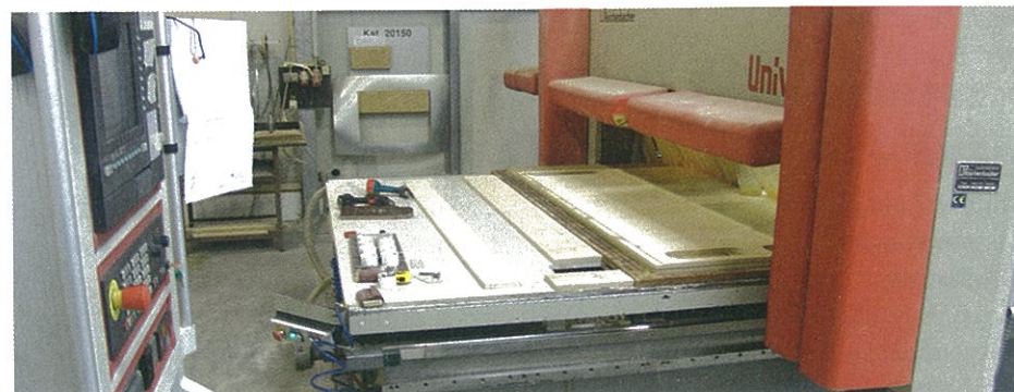
Der moderne „Allerschneider“ bearbeitet fast alle Materialien, nicht nur Paneele
