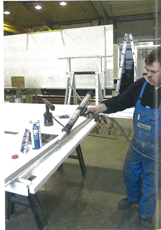
Kleben ist die herausragende Fügetechnik
